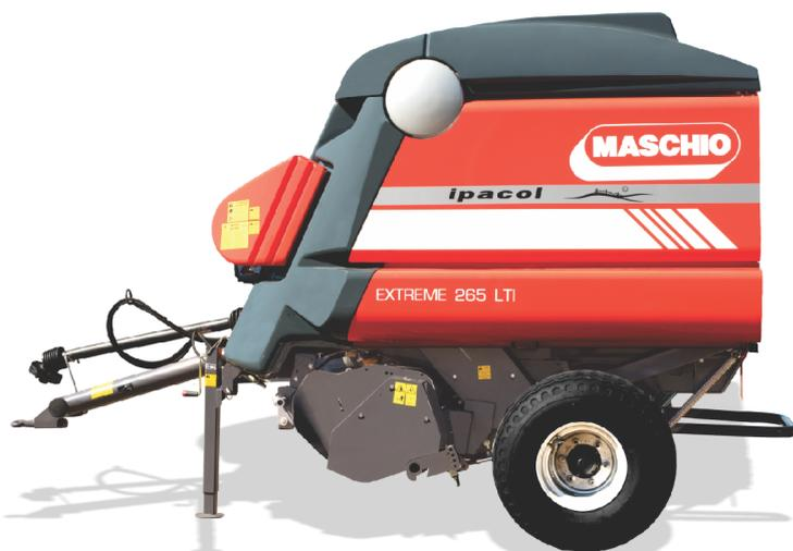
A Extreme 265 LTI exerce uma pressão constante desde o núcleo à camada externa: o valor pode ser facilmente definido a partir da unidade de controle existente na cabina do trator. O fardo assim formado distingue-se pelo seu “núcleo de baixa densidade” com diâmetro selecionável.
